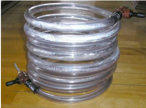
Enfriadores contracorriente en acero inoxidable de 6 metros (aisi 316) de 3/8" (9.5 mm diámetro y espesor 0.5 mm) con manguera transparente de 3/4" (19 mm x 23 mm)
