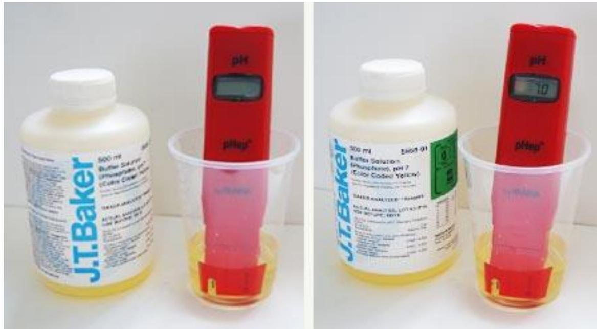
**Calibración con 2 puntos y a temperatura ambiente (25°C)**
